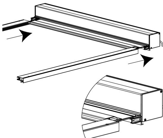
**Schritt 2: Schieben Sie die Führungsschienen unten am Kasten über die Konsolenzapfen.**
