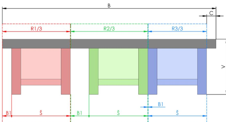
Das Rollo kann in die Öffnung oder vor die Öffnung (auf die Decke oder an die Wand) platziert werden. Breite und Höhe des Rollos wird folgenderweise gemessen:
