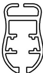
**Unterleiste für Stoffbespannung RBR/1**
