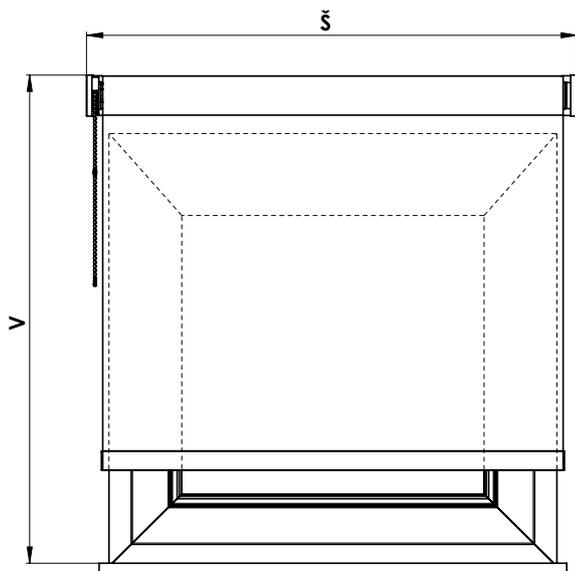
Das Rollo kann in die Öffnung oder vor die Öffnung (an die Decke oder an die Wand) angebracht werden. Breite und Höhe des Rollos wird folgenderweise gemessen:
