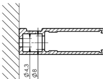
Führungsschiene von vorne gebohrt (VL-L30c)
