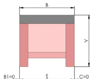
Rollo mit Halterungen ohne Bohrung
