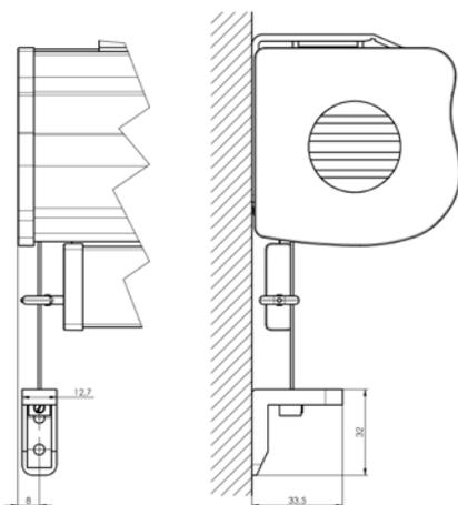
Seilführung mit Seilhalter für Montage in die Decke (L+K)
