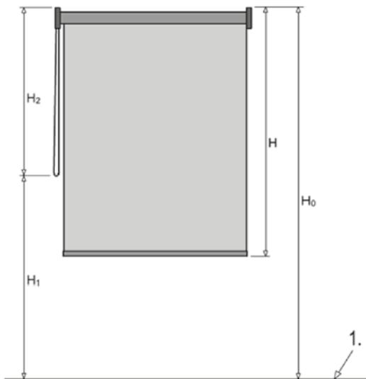
Die gefährliche Schlinge ist im Verlauf der folgenden Wirkung von Belastung 6 kg oder später bis 5 Sekunden nach der Wirkung beseitigt.
